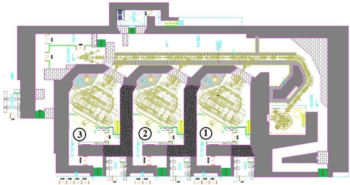
图 4-8 辐射工作场所控制区划分及联锁门示意图
