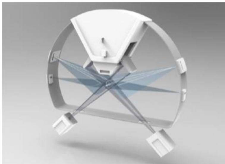
图 3-14 旋转束治疗室 X 射线管位置示意图
