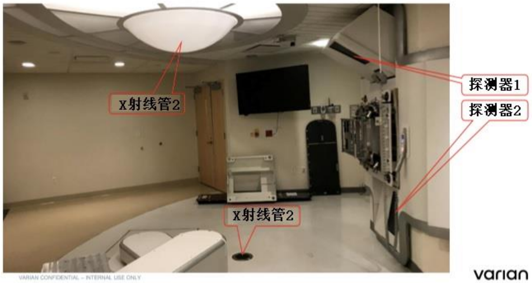
图 3-13 固定束治疗室 X 示意图射线管位置
